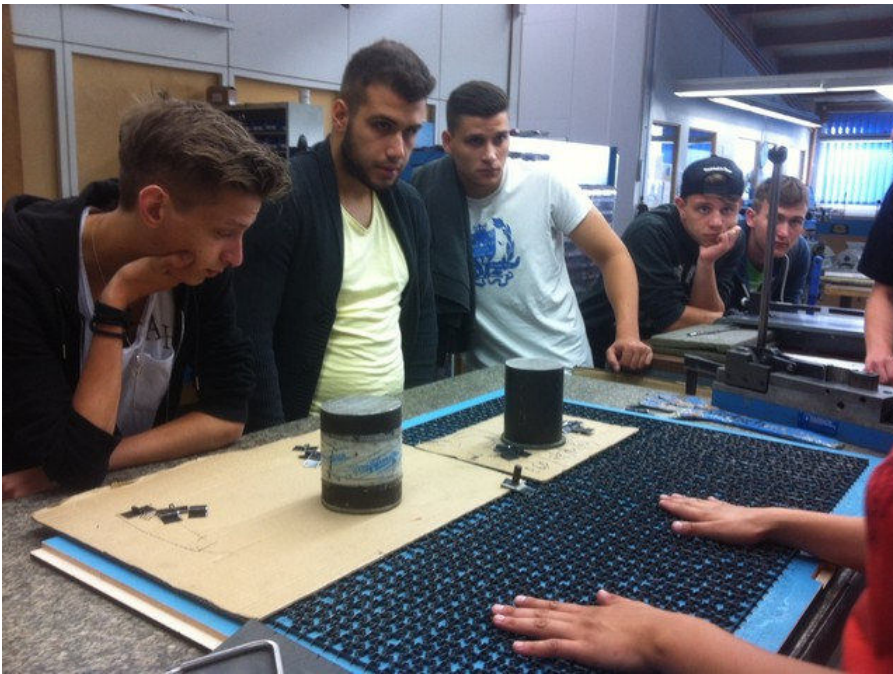
Die Fertigung mit Stanzwerkzeugen für Puzzle
